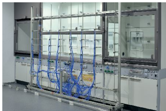
Прошедший испытания на DIN EN 14175-T6 блок управления вытяжным шкафом в соответствии с 5.4
